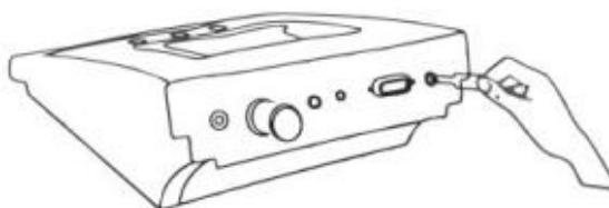
将电源适配器的电缆与仪器的直流电源接头连接仪器
