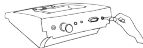
将电源适配器的电缆与仪器的直流电源接头连接仪器
