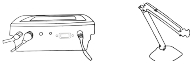
连接电极和温度传感器与其对应接口
