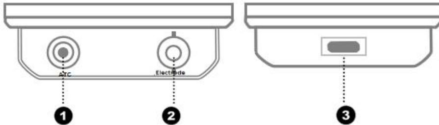
1.ATC温度探头接口    2.Electrode电极接口    3.USB Type-C接口
